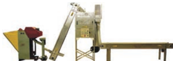
Линия за чулене на орех, която включва: машина за чулене, обдухвател, транспортна лента, доначупваща машина, сортираща маса и вибрационно сито за ядка
