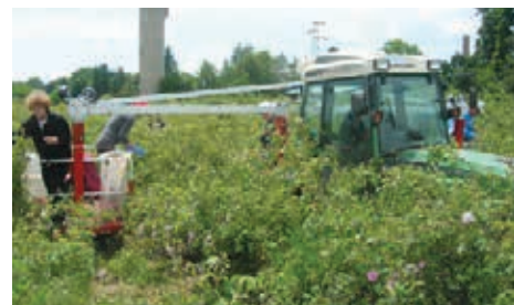
Фигура 2. Експлоатационно изпитване на тримодулната машина за рози
