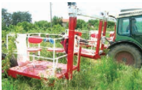
Фигура 1. Опитен образец на тримодулна работна машина за механизирани прибирането на цвета от насаждения с маслодайна роза
